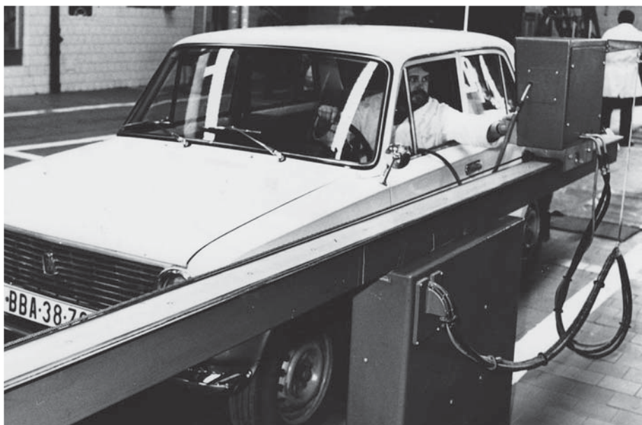
Obr. 1: V prvej stanici technickej kontroly na Slovensku, v Banskej Bystrici, boli použité na linkách pre osobné automobily valcové skúšobné brzd od nemeckej spoločnosti Hofmann, typu Brekon 1
