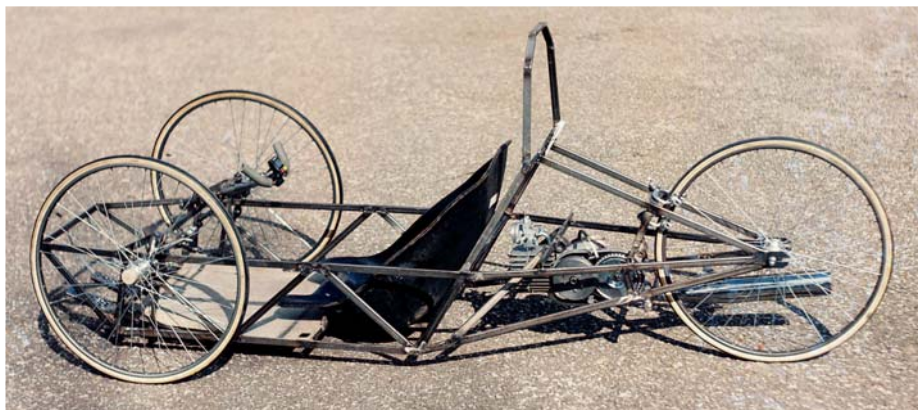
Obr. 1 Kompletný základný rám a ovládanie vozidla - pedále brzd a plynu
