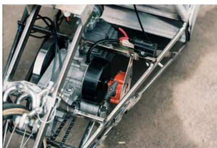
Obr. 2 Skúšanie pôvodného motora na stende a jeho umiestnenie v ráme
